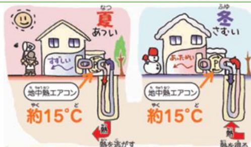
図 7-18 地中熱利用の仕組み
